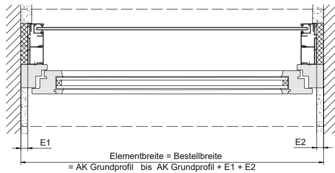
Horizontalschnitt Einzelanlage Motorseite rechts oder links von innen gesehen
