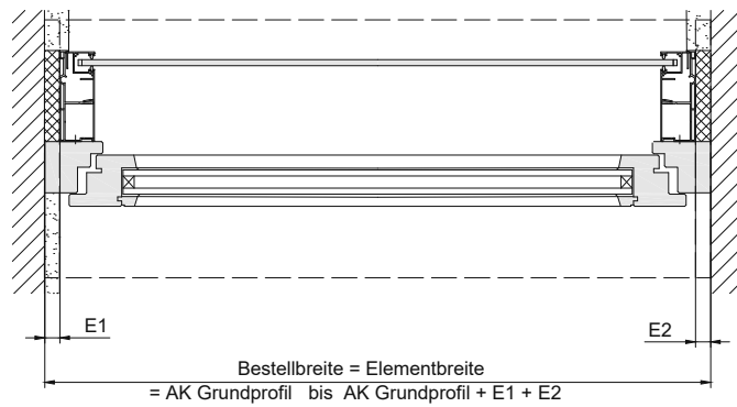
Horizontalschnitt Einzelanlage Motorseite rechts oder links von innen gesehen
