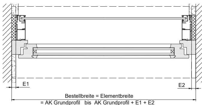
Horizontalschnitt Einzelanlage Motor rechts oder links von innen gesehen
