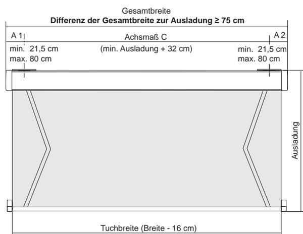
Ist die Differenz der Gesamtbreite zur Ausladung  $\geq 75$  cm, kann das Achsmaß\*\* zwischen 21,5 cm und 80 cm, in Abhängigkeit der Ausladung, variieren.
