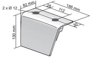
Distanzplatte aus Aluminium, für die Deckenmontage, zum Ausgleich von unebenen Untergründen (Zubehör)
