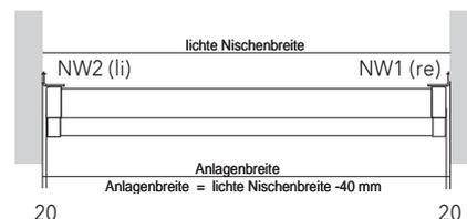
Bei Montagevariante 2 müssen die Nischenwinkel getauscht werden.
