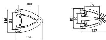
Bodenkonsole zu Typ A1, B1 zum Einbetonieren
