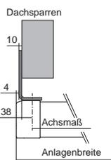
Konsole rechts montiert
