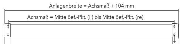
**Hinweis:** Für Ausladungen bis max. 300 cm empfohlen. Bitte vorher unbedingt Statik der Unterkonstruktion prüfen. Skizze mit Lage der Markise, der Dachsparrenwinkel (inkl. Einbaulage) und der Dachsparren anfertigen. Die Konsolen können bei art\_01 nur ganz außen im Bereich der Funktionslager montiert werden. Das Achsmaß kann nicht verändert werden. Die Anlagenbreite muss auf die Dachsparren bzw. das Achsmaß angepasst werden.
