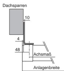
Konsole links montiert
